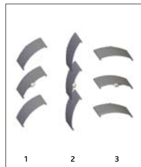
Position de travail: 1. Les lames descendent en position ouverte à 37°. 2. Lames fermées. 3. Les lames remontent en position ouverte.
