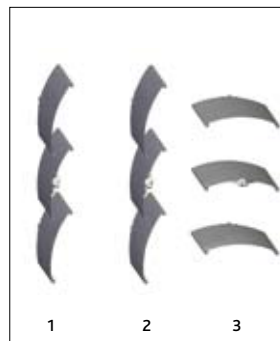
Version classique: 1. Les lames descendent en position fermée. 2. Lames fermées. 3. Les lames remontent en position ouverte.
