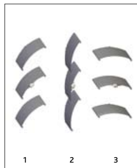
Position de travail: 1. Les lames descendent en position ouverte à 37°. 2. Lames fermées. 3. Les lames remontent en position ouverte.
