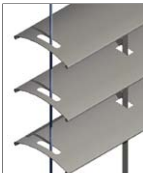
Passage du câble dans les lames
